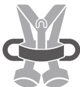
Der Arbeitspositionierungsgurt kann alleine verwendet werden (Rückhalt) oder in einen Auffanggurt integriert sein (Arbeitspositionierung). Das Arbeitspositionierungsseil verbindet einen Gurt an einem Anschlagpunkt (Rückhalt), oder an einer Struktur indem er die Person so umgibt, daß die Hände losgelassen werden können (Arbeitsplatzpositionierung).
