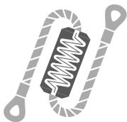
Der Energieabsorber wird notwendigerweise in Situationen verwendet, in denen der Benutzer einer Sturzgefahr ausgesetzt ist. Das Auffangband dient dazu, im Falle eines Sturzes Energie abzuleiten und die Bremskraft auf ein Nichtverletzungsniveau zu begrenzen.
