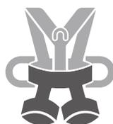
Der Gürtel mit Beinschlaufen ist ein um die Taille gewickeltes Textilelement, das mit jedem Bein verbunden und mit einem ventralen Befestigungspunkt ausgestattet ist, der das Aufhängen einer Person ermöglicht.
